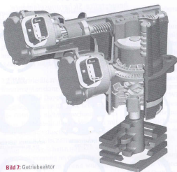
Bild 7: Getriebeaktor mit „Active Interlock“
